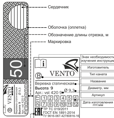
Рис. 1. Составные части и маркировка изделия
