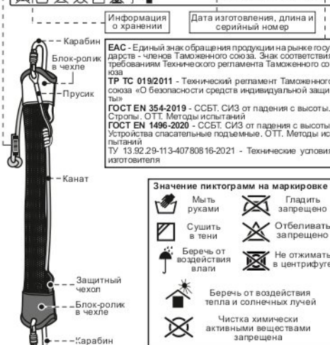
Рис. 7. Использование полиспаста в спасательно-эвакуационных работах
