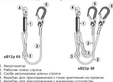
Рис. 1. Внешний вид, состав стропов
