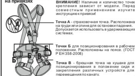
Рис. 5. Способы крепления к анкерным устройствам
