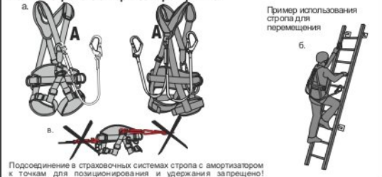
Рис. 6. Использование карабинов, входящих в состав стропов
