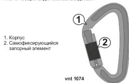
Рис. 1. Общий вид и составные детали
