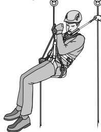
Рис. 11. Пример организации системы канатного доступа
