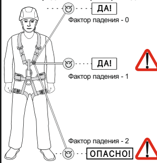
Рис. 7. Графическая схема к определению фактора падения
