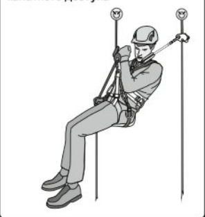
Рис. 12. Пример организации системы канатного доступа
