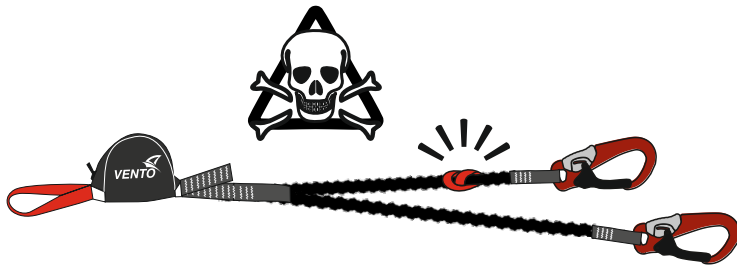
Рис. 8. Проверка перед применением самостраховки
