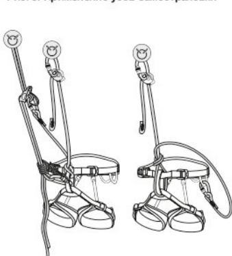
Рис. 8. Применение усов самостраховки
