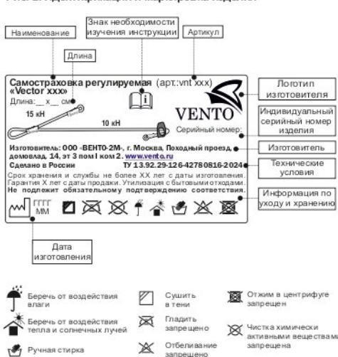
Рис. 2. Идентификация и маркировка изделия
